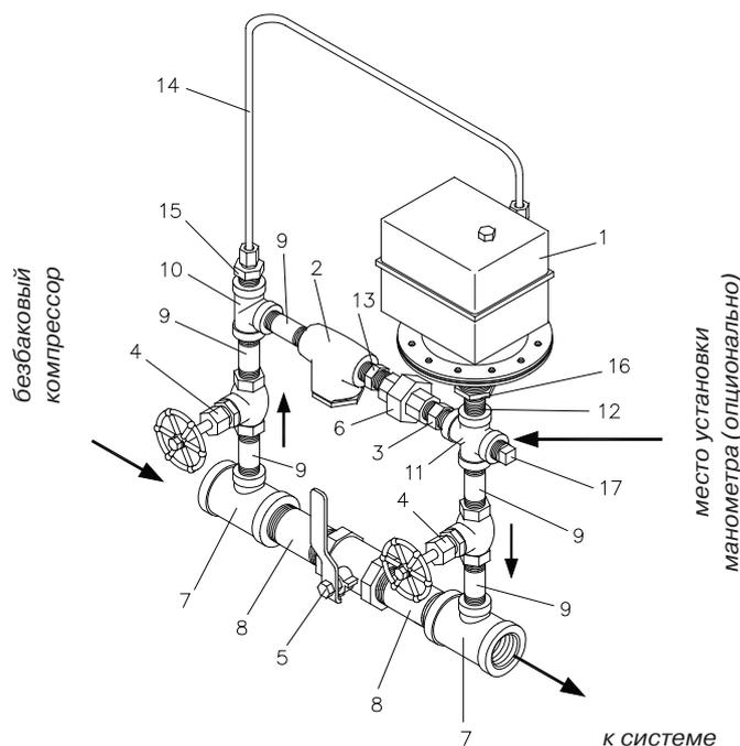
**Схема установки устройства поддержания давления модели А2 с воздушным клапаном модели D**
