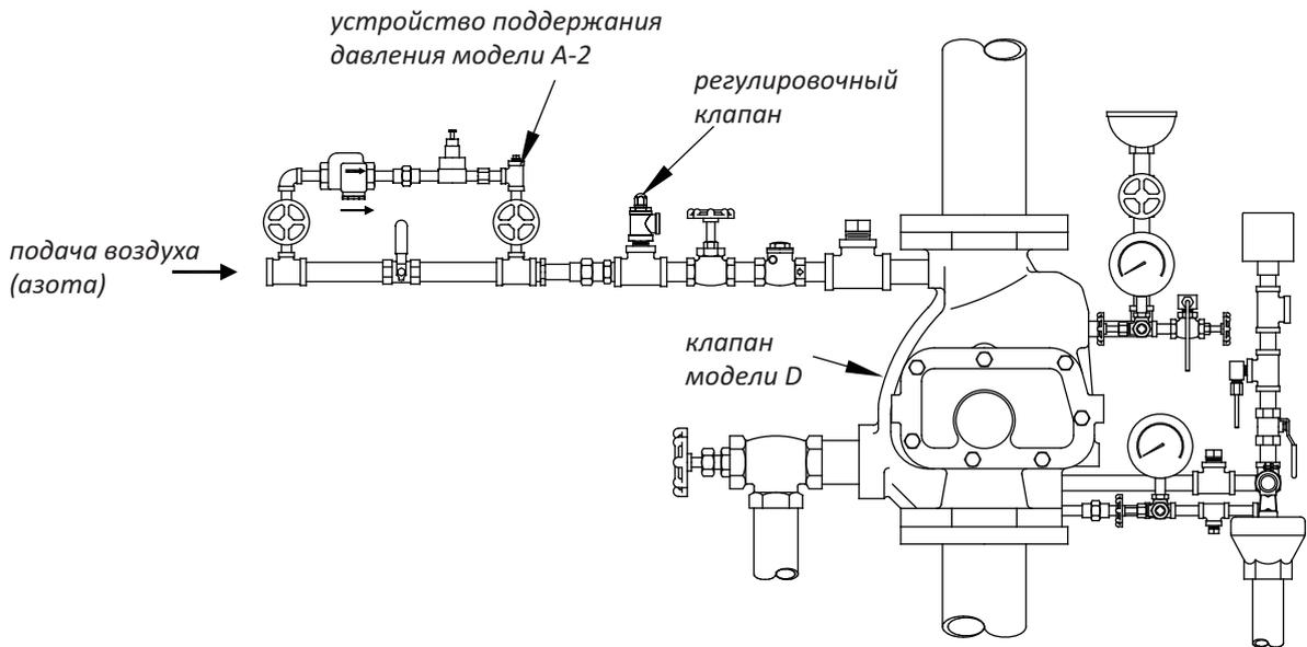
**Схема установки устройства поддержания давления модели В-1 с воздушным клапаном модели D**
