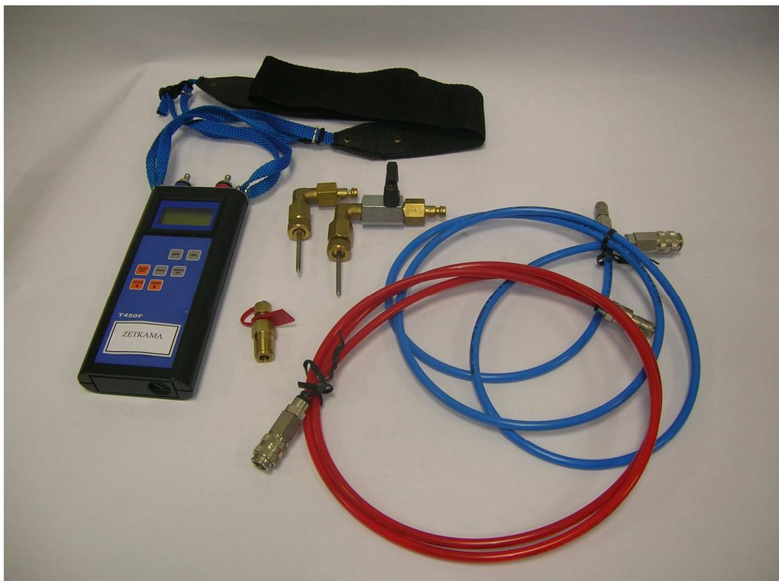
Для снятия показаний и регулировки можно использовать электронный прибор. Записанные в нём характеристики балансировочных клапанов ZETKAMA позволяют на прямое снятие показаний напора. Прибор позволяет на измерение перепада давления, температуры и имеет возможность регистрирования. Точное описание прибора можно найти к каталожных картах производителя прибора.
