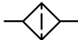
Основные **области применения** таких фильтров - механическая очистка рабочей среды от грязи, ржавчины, стружки и т. д. в системах отопления, тепло-водоснабжения и системах кондиционирования. Подробнее про ХВС, ГВС и прочее водоснабжение, а про теплоснабжение. Также данную конструкцию можно использовать на воздух, азот, масла, углекислый газ, природный (натуральный) газ и другие нейтральные жидкости и газы.
