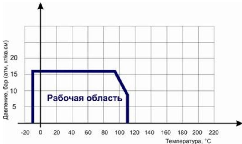
Диаграмма определяет рабочую область для фильтра сетчатого латунного резьбового в координатах Давление (в барах / Температура (° C)).
