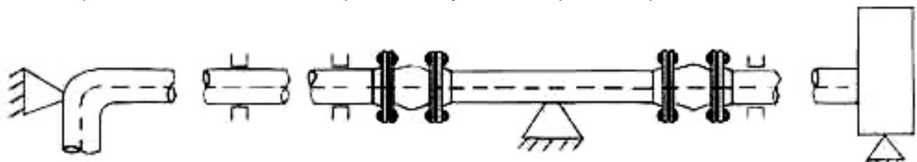
4. Гибкие вставки следует устанавливать непосредственно за неподвижной опорой. За гибкой вставкой следует предусмотреть подвижные опоры
