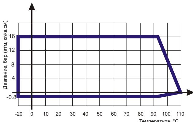
Диаграмма определяет рабочую область для вставок гибких фланцевых и резьбовых - антивibrationных компенсаторов в координатах
